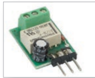
BMA Adapter, Art.Nr. 22630 Abmessungen: 33 x 19 x 12 mm
